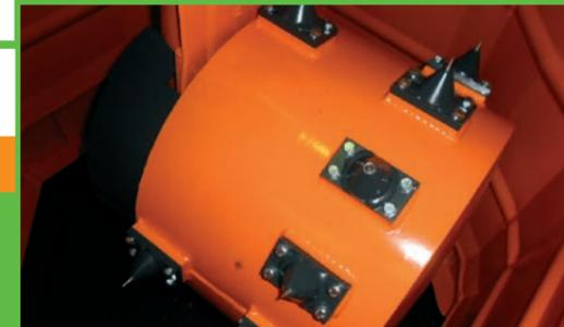
Rodillos especiales con tacos intercambiables para la compactación de plásticos de burbujas, botellas de plástico de PVC, plástico suave, pilas de frutas y verduras entre otras muchas cosas.
