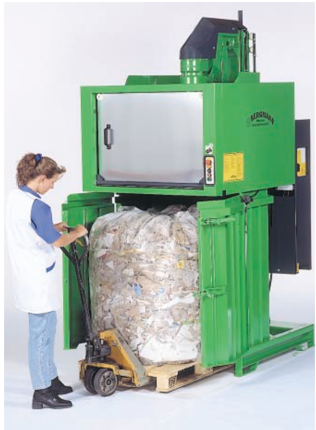
4. La matière hautement compactée s'enlève et se transporte facilement.
